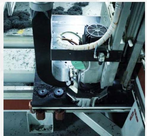
*Piezas de hasta 120" x 60" x 5" a 22000 rpm máximo.*
